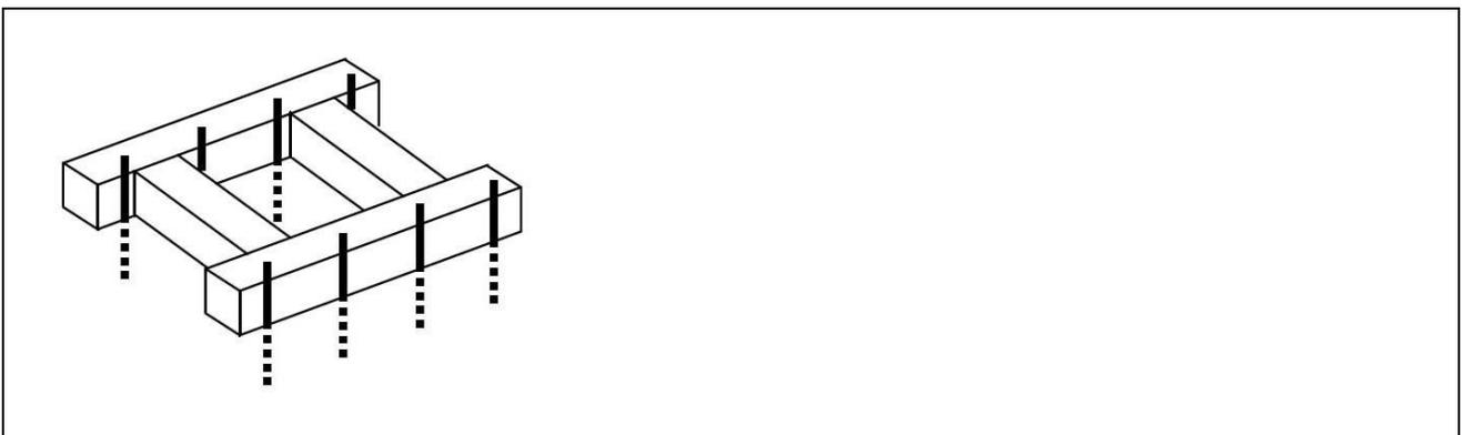
**Advertencia:** una vez terminado se necesita poner un elemento de protección en las cabezas de las varillas.
