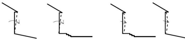
volteo afuera del plano de muro      pandeo de muro
